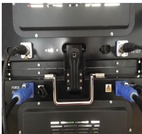
上下相邻箱体之间用锁扣锁紧 用 M6 内六角扳手将螺钉锁紧 图 14. 箱体安装图
