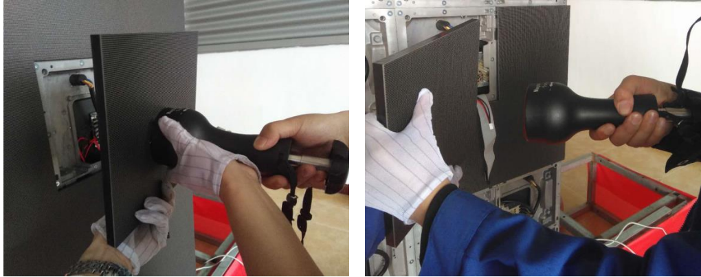
图 21. 模组和磁吸工具分离
