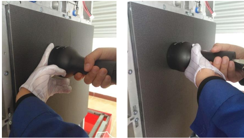
图 18. 磁吸工具贴近灯珠表面
