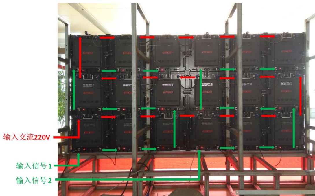
图 15. 箱体间信号线及电源线连接示例
